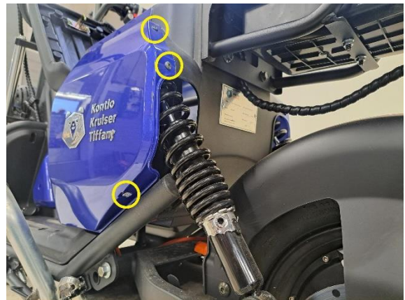
Irrota istuimen vasemmanpuoleisen alasivumuovin kiinnitysruuvit (ristipäämeisseli ph2).
