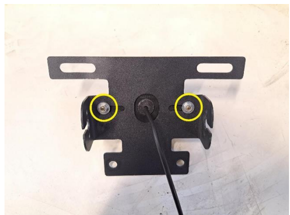
Irrota takavalon kiinnitysmutterit (kiintoavain 7 mm) takavalon kiinnikkeestä.
