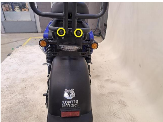
Irrota selkänojan ja takavalon kiinnikkeen kiinnityspultit (kiintoavain 10 mm).
