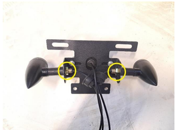
Irrota takavilkkujen kiinnitysmutterit (kiintoavain 14 mm) takavalon kiinnikkeestä.
