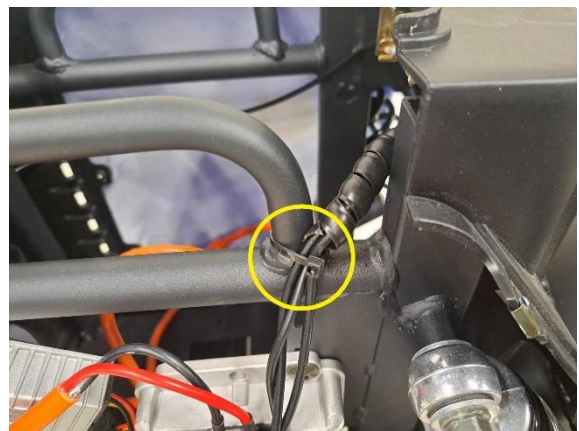
Katkaise takavalojen johtoja kiinni pitävä nippuside (sivuleikkurit).
