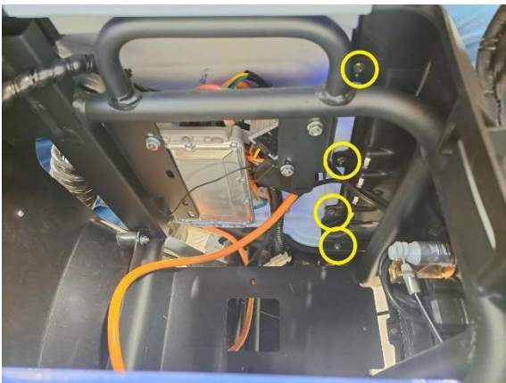
Irrota istuimen vasemmanpuoleisen alasivumuovin kiinnitysruuvit (ristipäämeisseli ph2).
